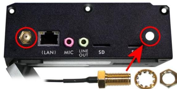
7. Am anderen Ende des Antennenkabels befindet sich ein winziger Stecker. Verbinden Sie beide Antennenkabel mit den entsprechenden Anschlüssen auf der M.2-4G/LTE-Karte (siehe Bild).
