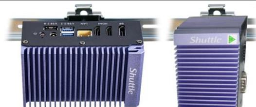
... damit nach der Montage auf der Hutschiene die Anschlüsse des Edge-PCs nach oben und unten ausgerichtet sind (siehe linkes Bild) und nicht seitlich (siehe rechtes Bild).
