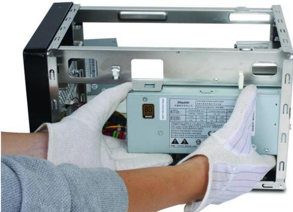
① Setzen Sie das Netzteil an die Einbauposition und befestigen Sie es mit drei Kreuzschlitzschrauben von der Rückseite.
