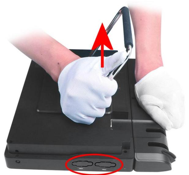
3. Entfernen Sie die perforierten Abdeckungen am Gehäuse, wo die neuen COM-Ports eingebaut werden.
