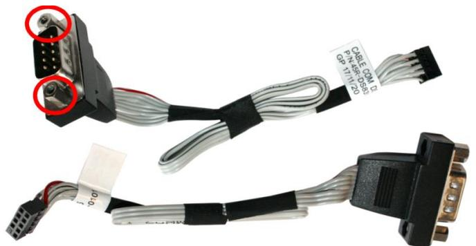
5. Bauen Sie die beiden D-Sub-Anschlüsse der COM-Port-Adapter PCP21 mit den mitgelieferten Schrauben in die Gehäuseöffnung ein.
