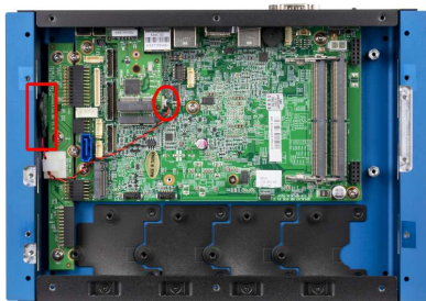
Foto: Position der Knopfzellen-Batterie und des Anschlusses auf dem Mainboard bei geöffnetem Computer-Gehäuse.
