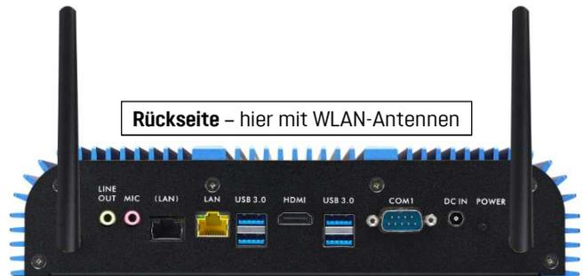
Rückseite – hier mit WLAN-Antennen
