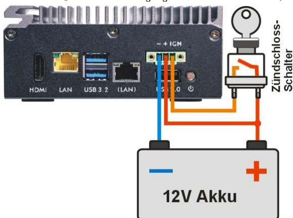
Die Einschaltverzögerung (0, 5, 10, 30, 60 Sek.) und Ausschaltverzögerung (0, 1, 3, 5, 10, 30, 60, 90, 120, 240, 360 Min.) lässt sich im BIOS-Setup unter der Einstellung "NVR Power Delay" auf der Seite "Advanced" vornehmen. Das BIOS-Setup-Programm wird aufgerufen, indem man kurz nach dem Einschalten des PCs die "Entf"-Taste drückt.
