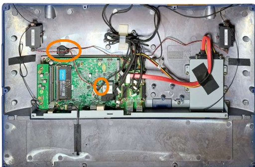
Foto: Position der Knopfzellen-Batterie und des Anschlusses auf dem Mainboard bei geöffnetem Computer-Gehäuse.
