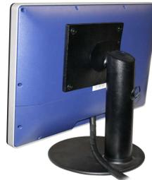
Durch eine kleine Öffnung werden die Kabel geordnet vom PC weggeführt, was für ein ordentliches Erscheinungsbild sorgt.
