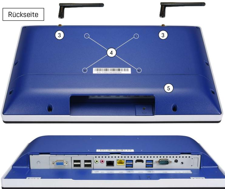
3. 2x SMA-Anschlüsse mit WLAN-Antennen
