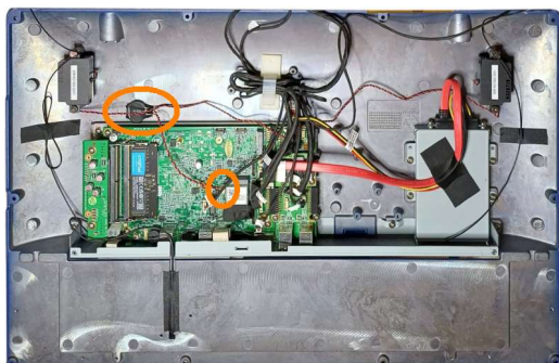
Foto: Position der Knopfzellen-Batterie und des Anschlusses auf dem Mainboard bei geöffnetem Computer-Gehäuse.
