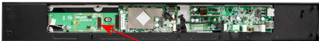
Das geöffnete D230 (Draufsicht): Position des M.2-Steckplatzes für das optionale LTE-Modul
