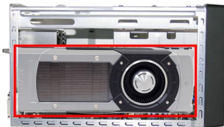
Maximale Länge der Karte: 273 mm
