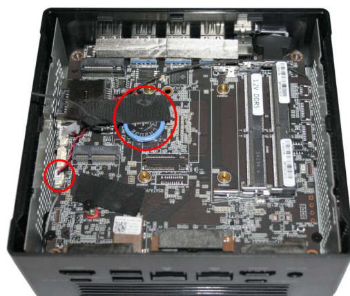
Knopfzellen-Batterie und des Anschlusses auf dem Mainboard bei geöffnetem Computer-Gehäuse.
