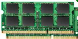
Bis zu zwei DDR4-2400/2666 SO-DIMM Speichermodule mit jeweils max. 32 GB
