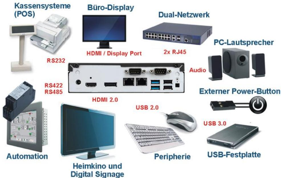
Das Shuttle XPC slim Barebone DH310V2 ist ein leistungsstarker und flexibler PC im stilvollen 1,3-Liter Slim-Gehäuse und eignet sich insbesondere für:
