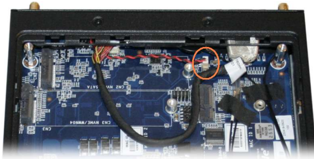
Foto: Position des Anschlusses der Knopfzellen-Batterie auf dem Mainboard bei geöffnetem Computer-Gehäuse.
