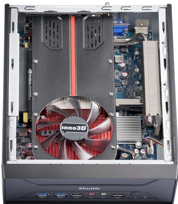
Trotz der geringen Gehäuseabmessungen verfügt der Shuttle XPC slim Barebone XH410G über einen vollwertigen PCI-Express-X16-Steckplatz für Single-Slot-Erweiterungskarten mit bis zu 208 mm Länge, 120 mm Höhe und 30 mm Breite und max. 75W Verlustleistung. Gleichzeitig werden leistungsstarke PC-Komponenten unterstützt, wie zum Beispiel ein Intel Core i9 Prozessor oder 64 GB RAM. Dies eröffnet zahlreiche Einsatzmöglichkeiten, für die man bisher oftmals einen wesentlich größeren PC benötigte.
