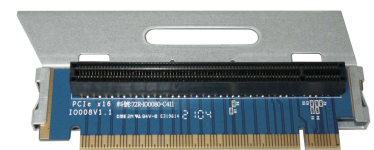
Riser-Karte mit PCI-Express X16 Slot
